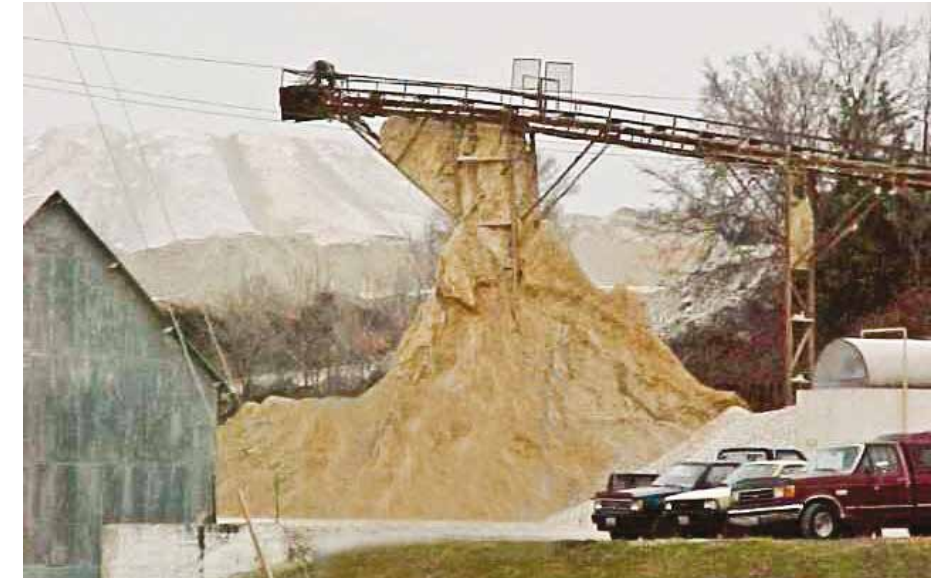
Yığın konveyöründe kum dökülmesi, boşaltım noktasına kadar ulaşabiliyor. Telif Hakkı © Martin Engineering 2023 Sand spillage reaching up to the discharge point on a stacker conveyor. Copyright © Martin Engineering 2023
