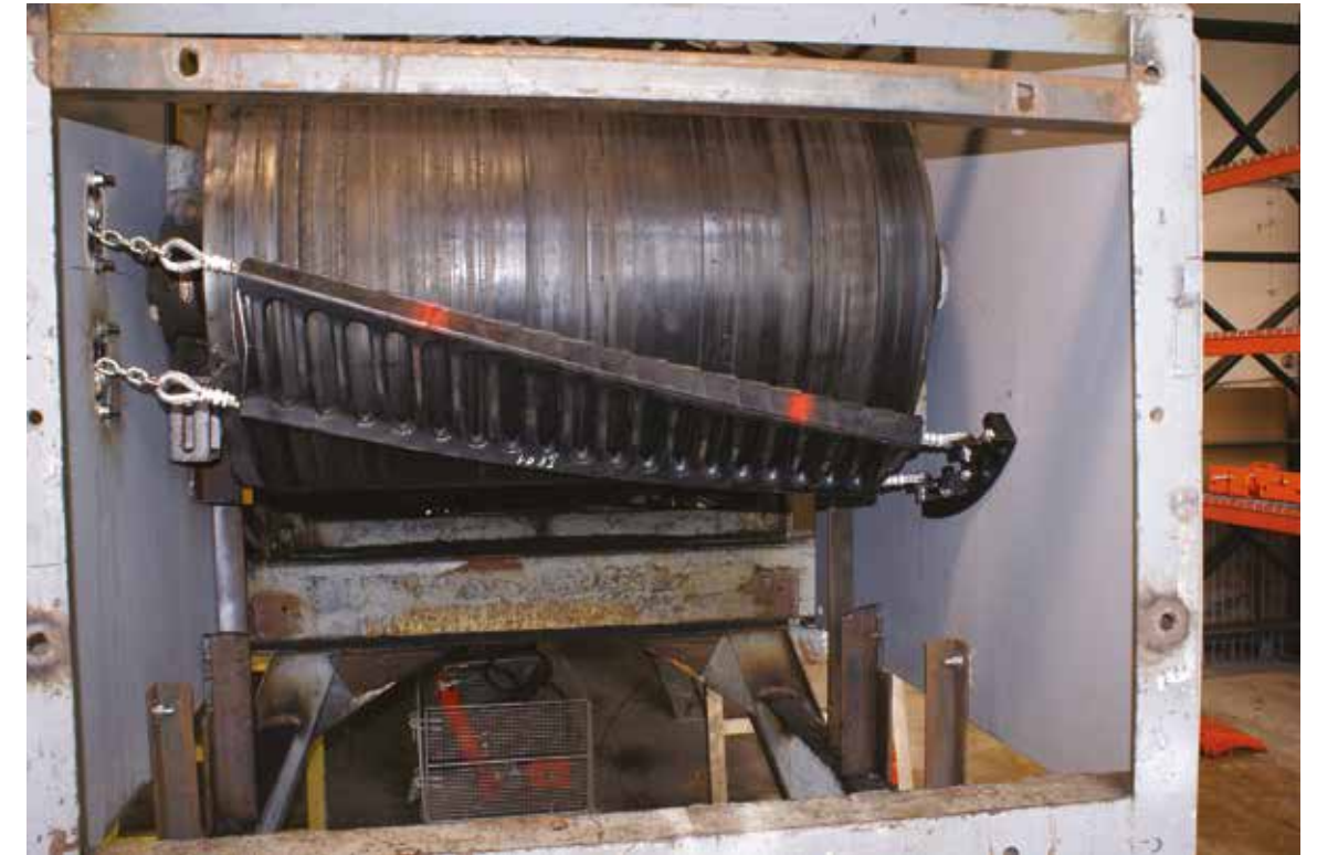
Yenilikçi yeni sıyırıcı tasarımları, daha az izleme gerektirir ve gergi ayarı ihtiyacını ortadan kaldırır. Telif Hakkı © Martin Engineering 2023 Innovative new cleaner designs require less monitoring and no tensioning. Copyright © Martin Engineering 2023
